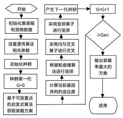
Figure 10. Flowchart of hybrid algorithm 图 10. 混合算法流程图
