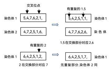
**Figure 9.** Schematic diagram of partial mapping cross **图 9.** 部分映射交叉示意图
