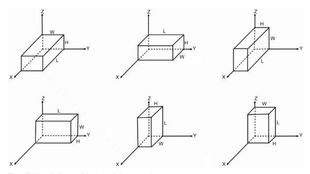
Figure 7. Schematic diagram of six rotational placement methods 图 7. 六种旋转放置方式示意图
