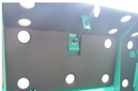
Figure 4. Hood + sound-absorbing cotton combination 图 4. 机罩 + 吸音棉组合方案
