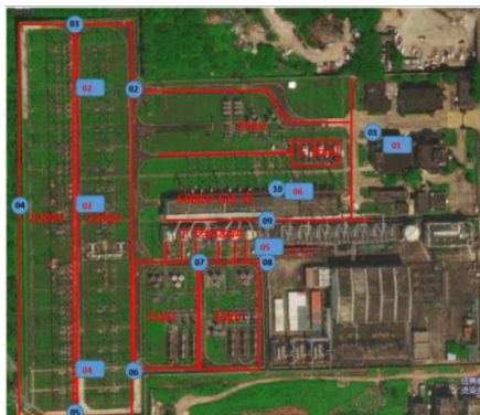
Figure 4. AP base station layout diagram of the 500 kV substation 图 4. 500 kV 变电站 AP 基站布置图
