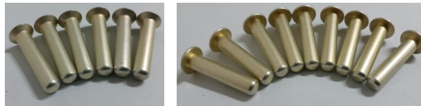
Figure 12. 7050 chamfered rivets 图 12. 7050 倒角铆钉
