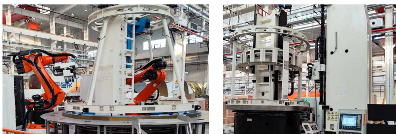
Figure 9. Automated assembly system of composite fairing 图 9. 复合材料整流罩的自动化装配系统
