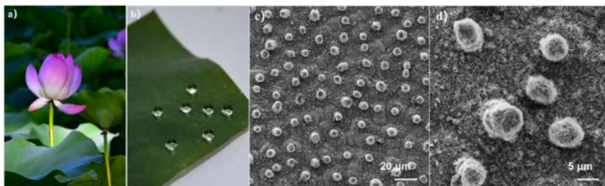
Figure 2. Macromorphology and microstructure of lotus leaf sample 图 2. 荷叶植物样品宏观形貌及微观结构图
